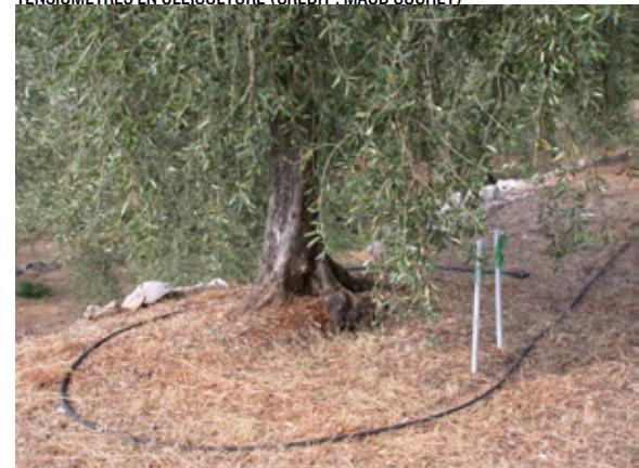
TENSIOMÈTRES EN OLÉICULTURE (CRÉDIT : MAUD CUCHET)
